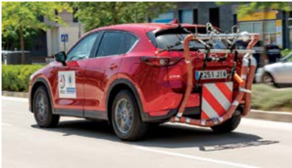
Figura 3 Vehículo sometido a un ensayo RDE.
